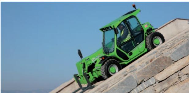
Das Temperament des Motors, der Wirkungsgrad des hydrostatischen Fahrtriebs und der permanente Allradantrieb gestatten die erfolgreiche und sichere Bewältigung nahezu aller Geländetypen auch bei starken Steigungen.
