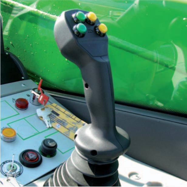
◀◀ Der Einsatz des Teleskoparms wird über eine Joystick-Steuerung hydraulisch-proportionalen Typs mit elektrischen On/Off-Tasten gesteuert (Foto links). Auf Wunsch ist der elektro-proportionale Joystick erhältlich (unten).
