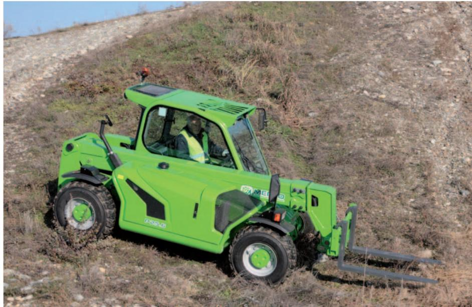
Der hydrostatische Fahrtrieb sorgt dank seiner hohen dynamischen Bremswirkung für minimalen Einsatz der Betriebsbremsen.
